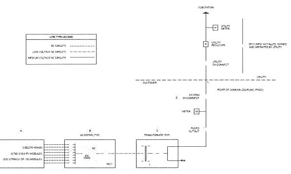
1 PV SYSTEM ONE-LINE DIAGRAM
